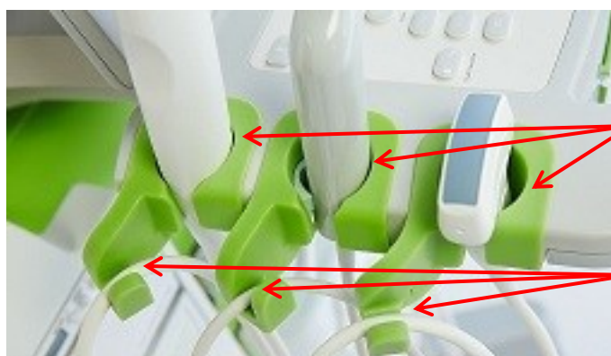
Figura 16. Soportes para transductores/gel y guías para cable
