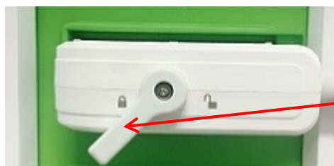
Figura 10. Orientación del conector del transductor
