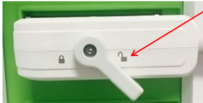
Figura 11. Palanca de bloqueo del conector del transductor desbloqueada
